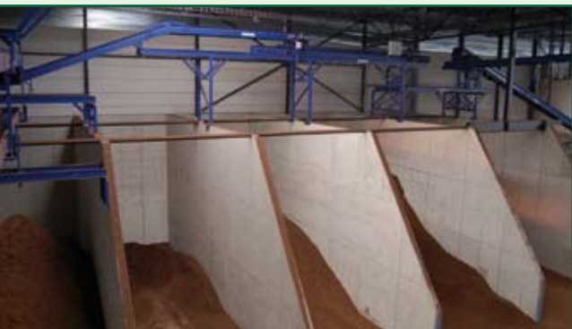
Opslagvakken met de diverse zeeffracties, die via beweegbare transportbanden worden gestort
