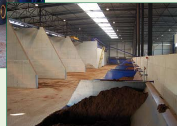
Overzicht van een deel van de hal met links de opslagvakken en midden op de foto de doseerbunkers met daaronder de centrale transportband. Op de achtergrond is het platform zichtbaar met de breek-/zeeflijn
