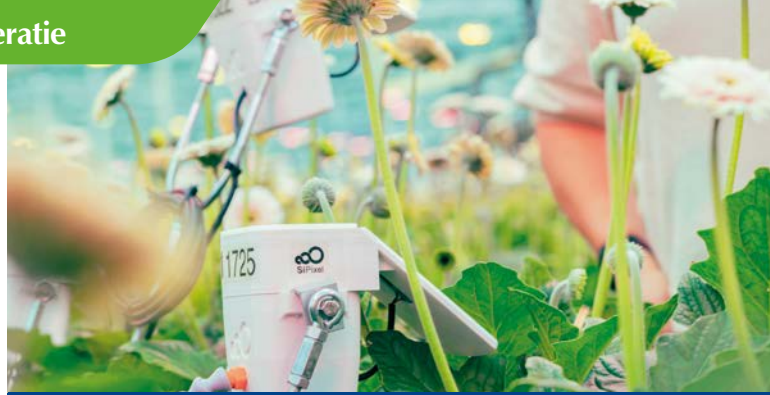
Camera's en sensoren tussen de gerberaplanten meten de vochtigheid en temperatuur
